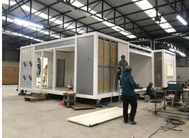
Figura 3: Trabalhadores atuando na fabricação de módulo volumétrico na indústria [4]
