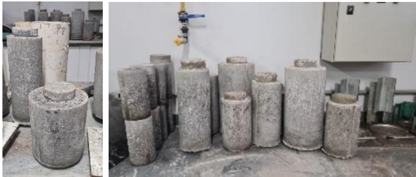
Figura 70: Corpos de prova com camisa de concreto novo
