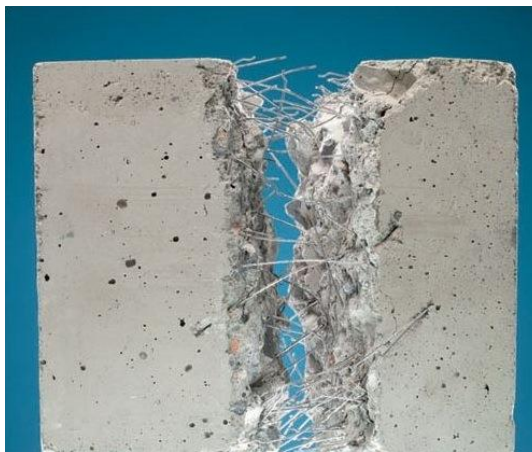
Figura 6 – Concreto com fibras de aço [9]
