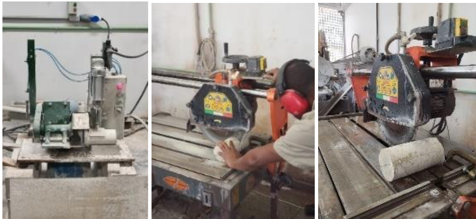
Figura 8: Retificação e recorte dos corpos de prova
