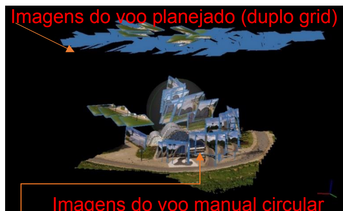
Figura 5 – processo da junção das imagens obtidas nos dois voos (duplo grid e manual) no programa Agisoft metashape . Fonte: autores
