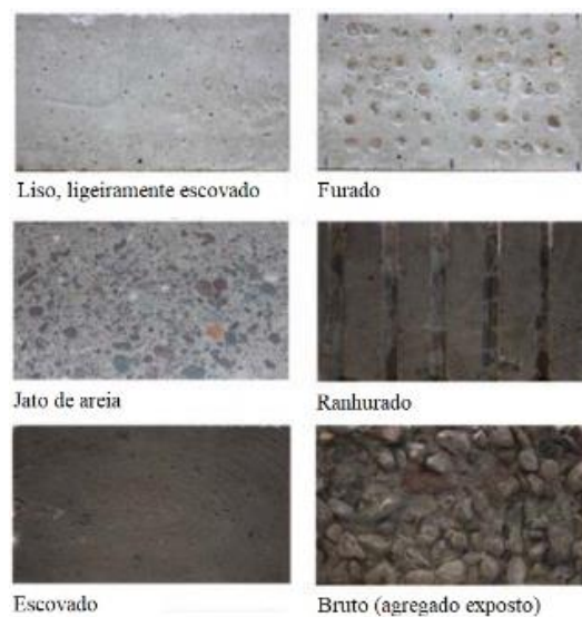
Figura 7: Tipos de tratamento da superfície de deslizamento
