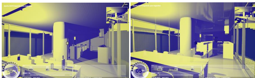
Figura 9 – Imagem false color para avaliação de iluminação (esquerda sem configuração de materiais, direita com as configurações)
