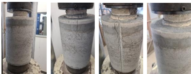
Figura 12: Ensaio de luva – Camisa H= 14cm e Espessura camisa= 4,6cm
