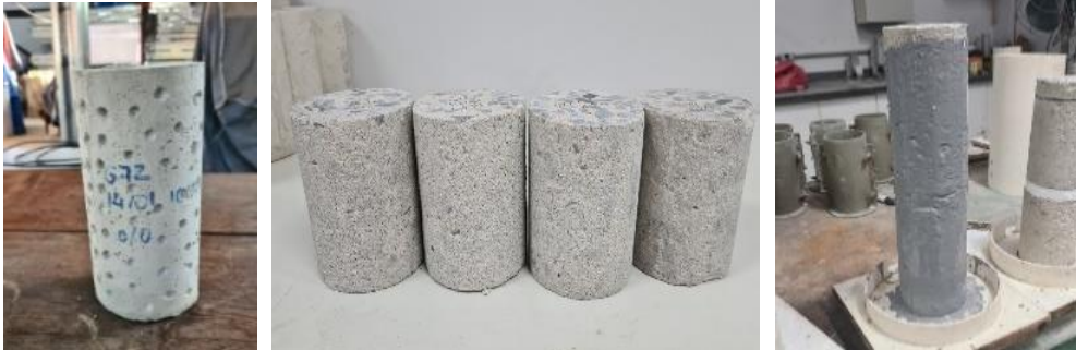
Figura 9: Tratamentos de superfície – Furos, lixamento e adesivo epóxi, respectivamente
